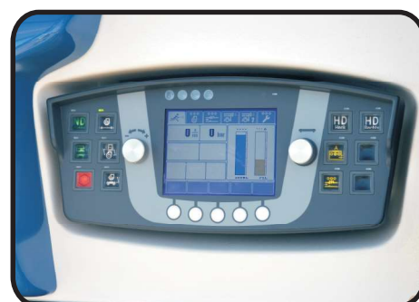
CANBUS-Fahrzeugsteuerung Unterstützung für den Maschinisten
